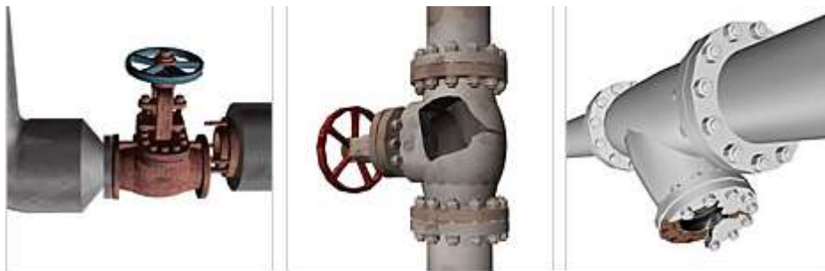
Exemple de conduites endommagées par des coups de bélièr
