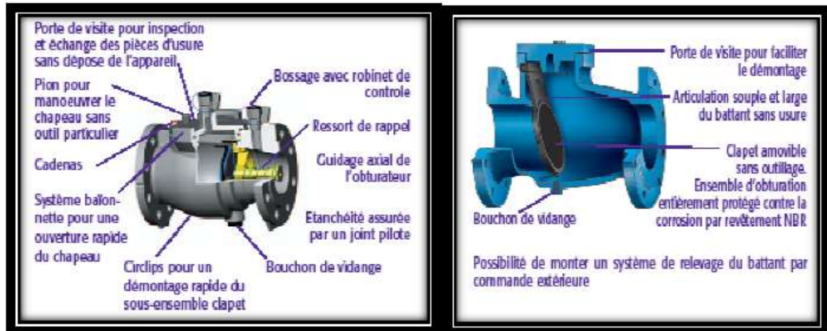
Figure 3.10: clapet à simple battant (à brides).
