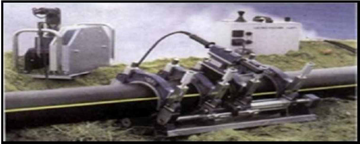
Figure 3.2 : bout à bout « bouseuse »
