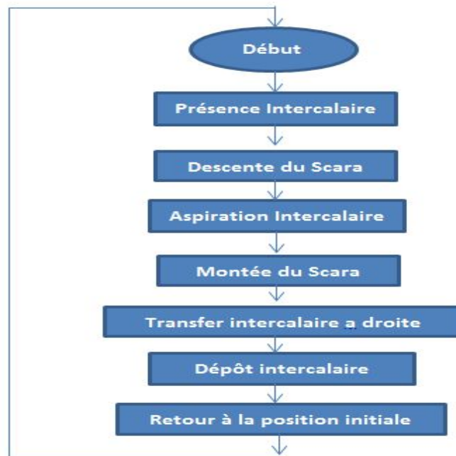
FIGURE III.18 – L'organigramme du fonctionnement du Bras Scara.
