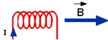
Figure I.7 : représentation du champ et courant dans une bobine.
