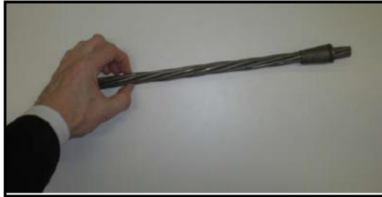
Toron avec clavettes à l'extrémité pour l'ancrage sur la tête
