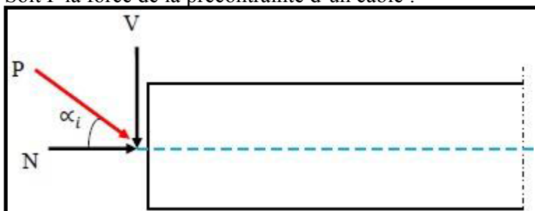
Fig.4: composantes de la force de précontrainte.
