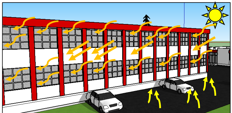
Fig. I. 75 : Causes de surchauffe des ateliers orientés Sud. Source : Auteurs.
