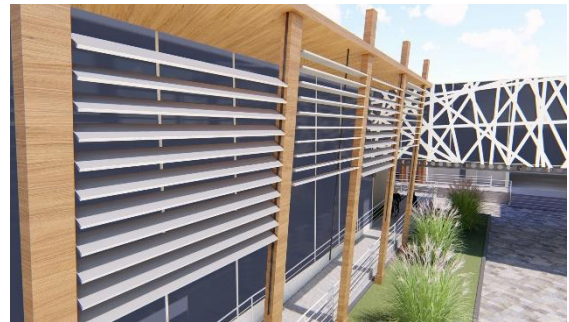
Fig. III. 75 : Brises soleils automatisés au niveau des galeries des façades Sud-Est Source : Auteurs.
