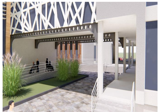
Fig. III. 33 : vue sur Structure mixte composé de poteau en B.A et poutre métallique. Source : Lycée-Cherieux.fr
