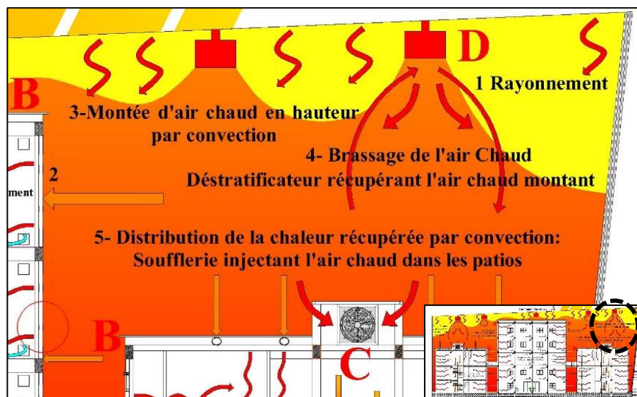
Fig. III. 44 : Brassage de l'air chaud par déstratificateurs thermiques en période froide.
