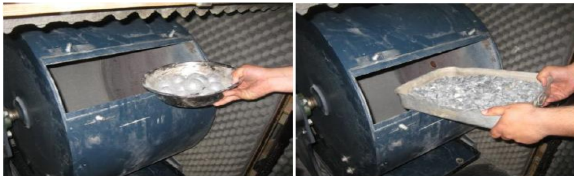
Figure V.5 : Mise en place des granulats pour l'essai Los Angeles.
