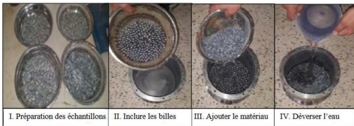
Figure V.2 : Mode opératoire de l'essai Micro Deval.
