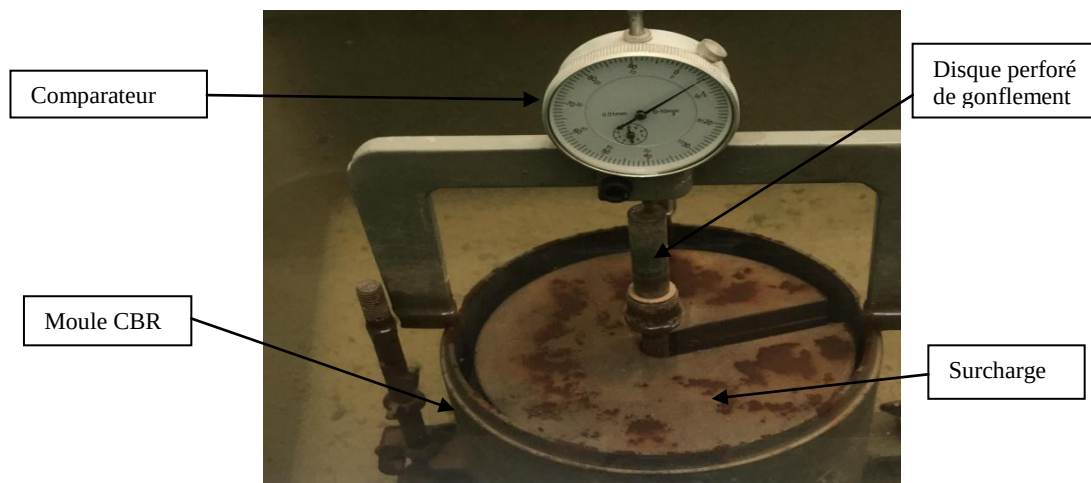
Figure IV.17 : Essai CBR après immersion, imbibition et gonflement.
