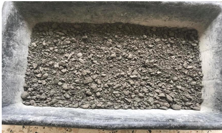
Figure IV.7 : Mélange de marne+ Débris de béton préparé pour essai Proctor.
