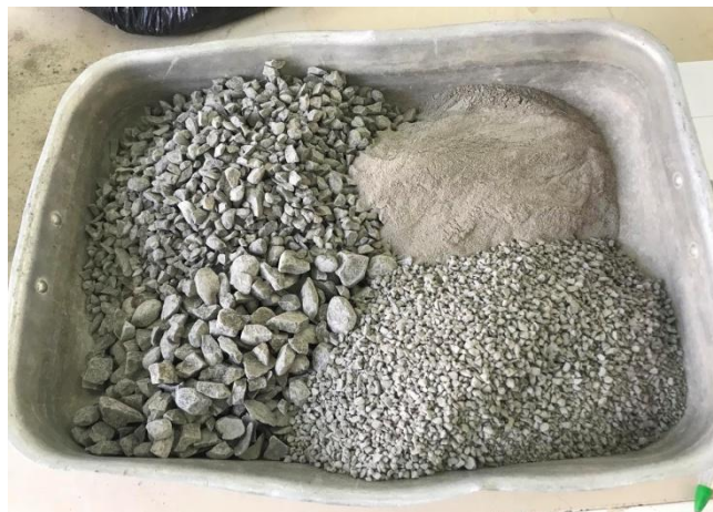
Figure III.19 : Débris de béton après concassage et tamisage.
