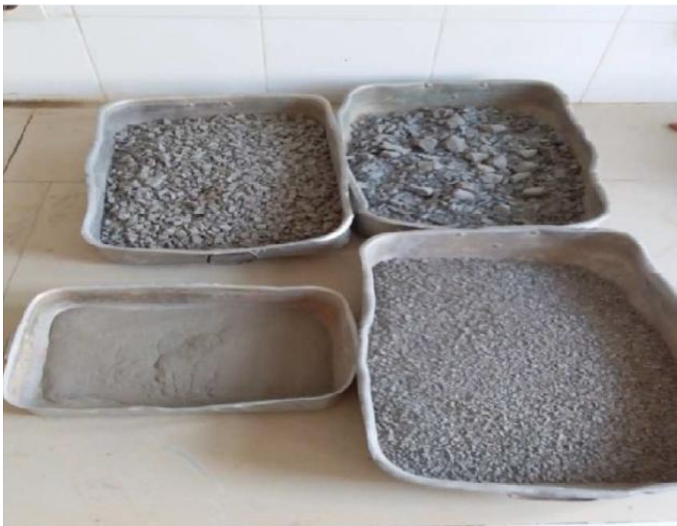
Figure III.10 : Granulats de marne après concassage et tamisage.
