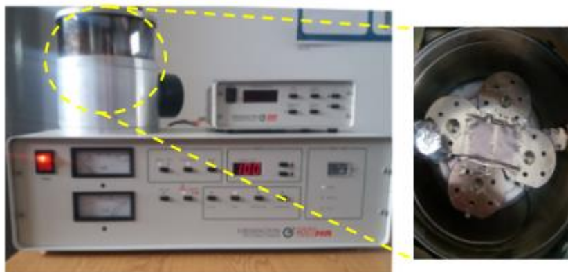
Figure 4. 4 Protocole de métallisation par évaporation sous vide.
