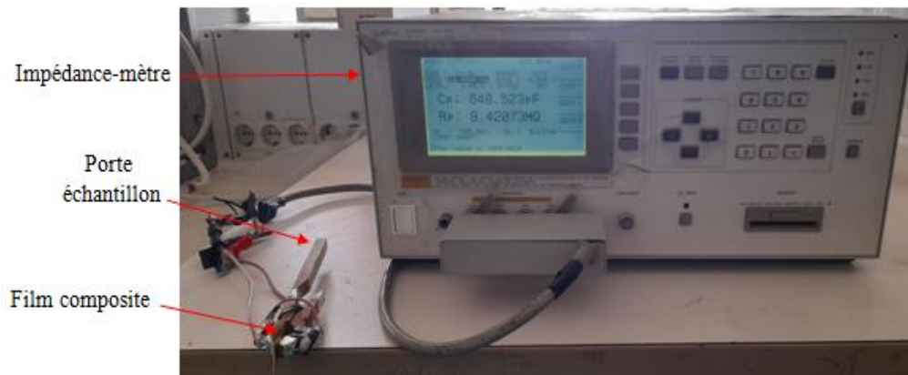
Figure 2. 6 Banc de mesure des propriétés diélectriques.
