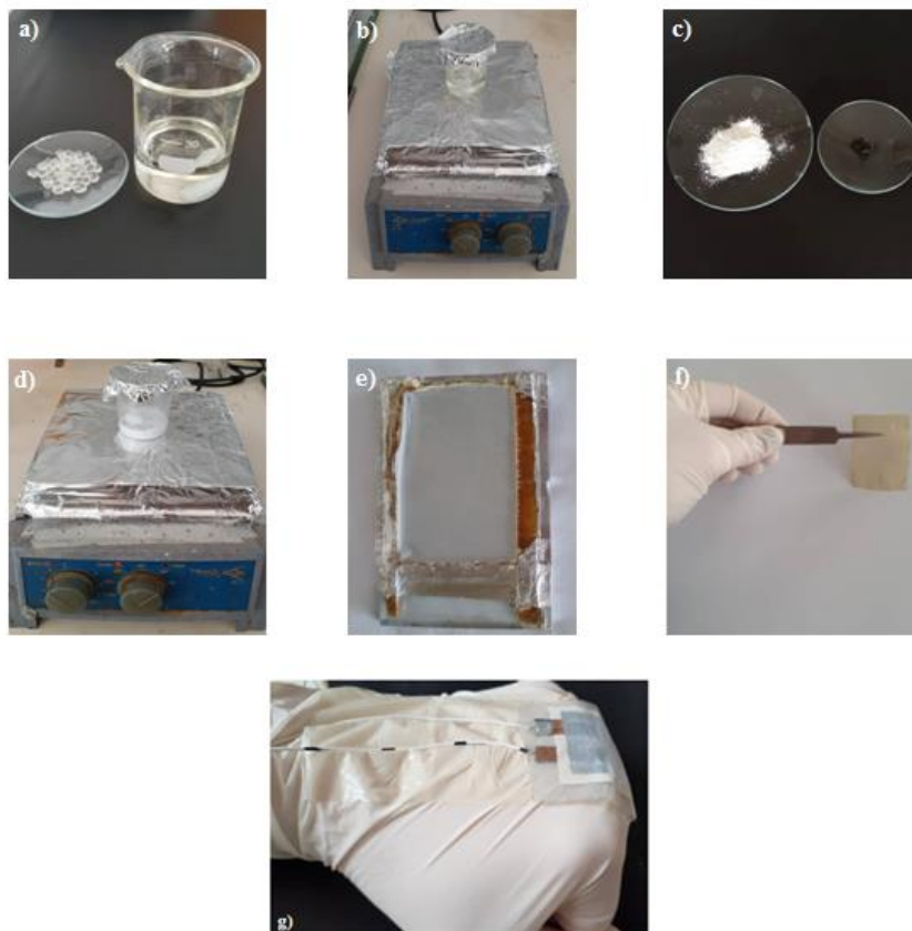
Figure 4. 5 Etapes d'élaboration du composite PU/NKLNT/FCs.
