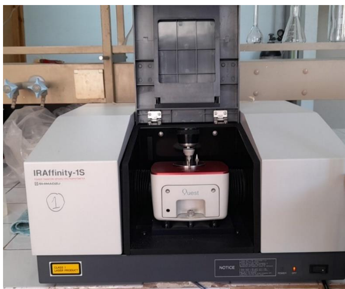
Figure 2. 4 Spectromètre infrarouge à transformée de Fourier.
