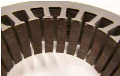
Fig. I.1 : Carcasse statorique feuilletée.
