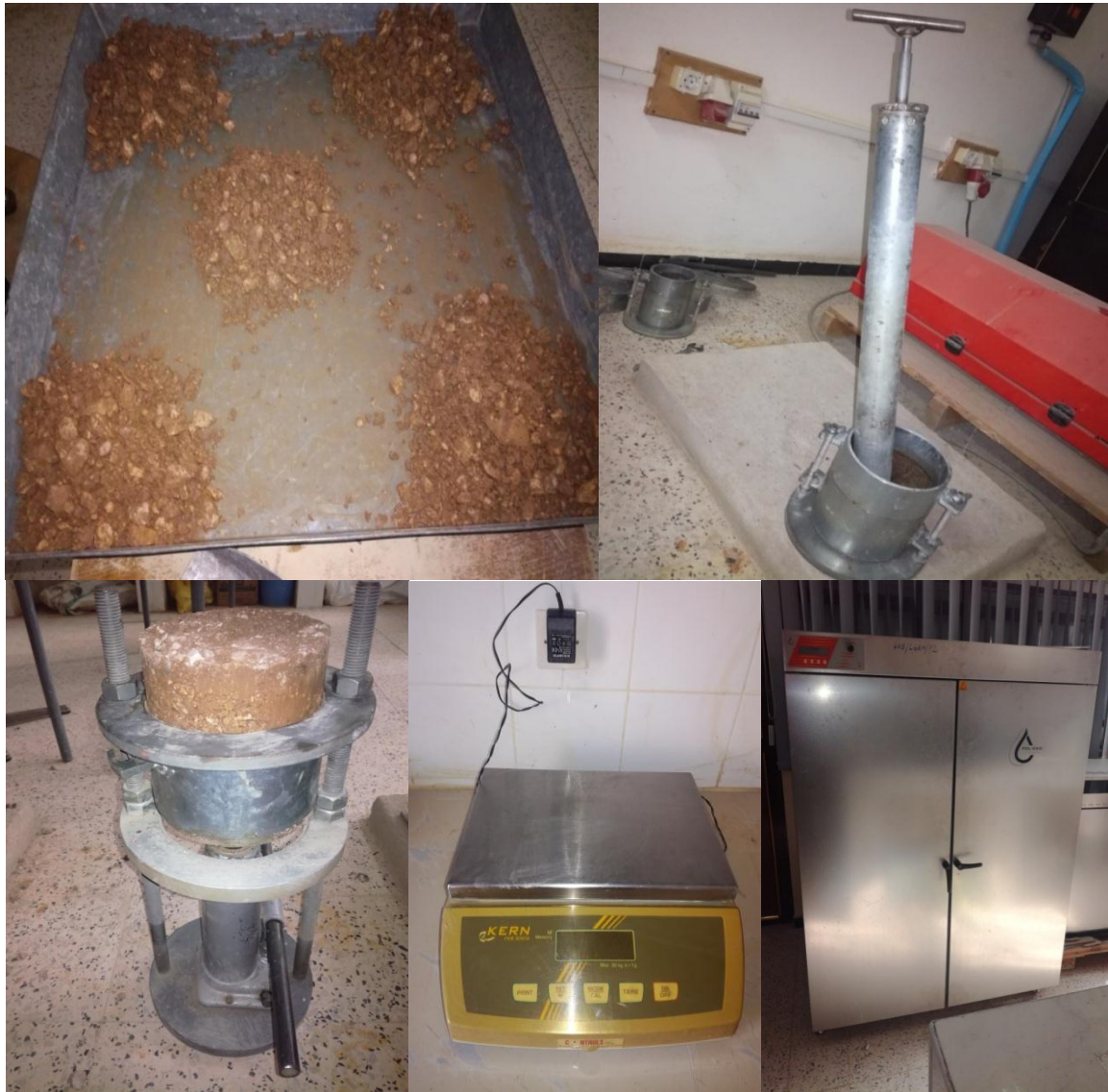
Figure III.15. Exécution de l'essai Proctor modifié.
