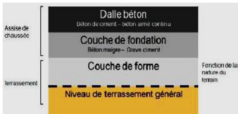
Figure I.9. Construction d'une chaussée en béton de ciment. (LCPC, 1994)
