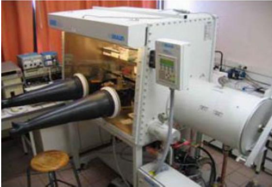
Figure II. 11: Photographie de la boîte à gants à atmosphère d'azote [13]
