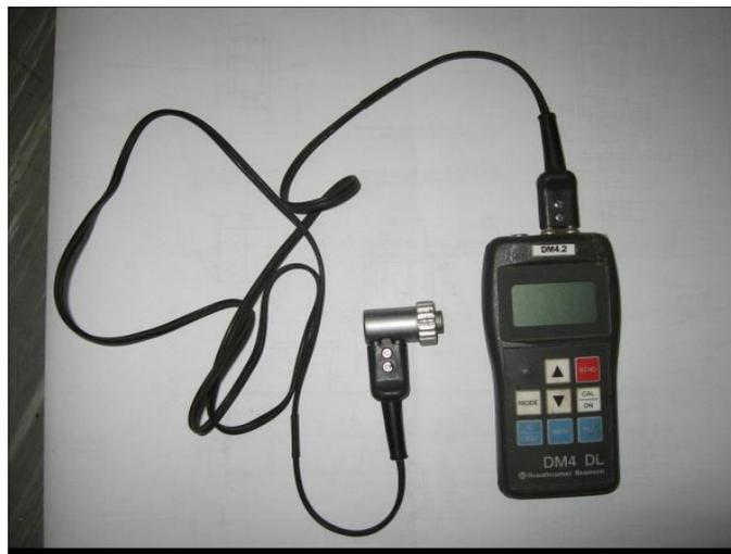
**Figure II.9:** appareil DM4 avec palpeur pour la prise d'épaisseur à l'ultrasons.
