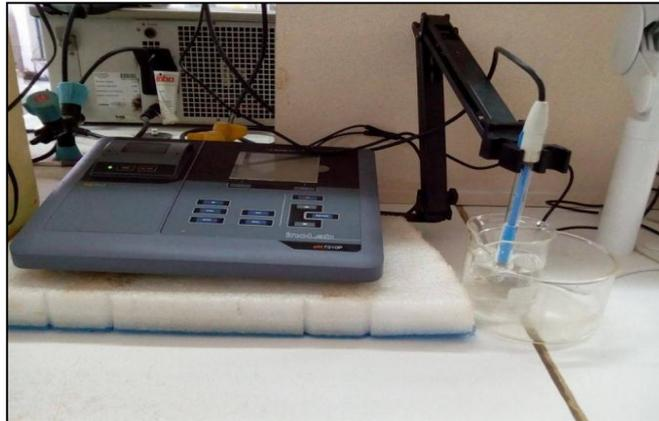
Figure II.4 : pH-mètre utilisé pour mesurer la valeur de pH.
