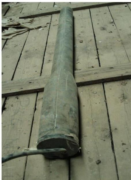
**Figure III.1** : Anode sacrificielle en ferro-silicium
