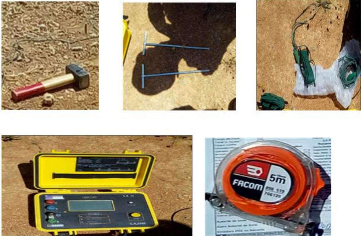
**Figure II.1:** Les différents éléments utilisés pour mesurer la résistivité du sol : a) marteau, b) les sondes en aciers inoxydables, c) les câbles de connexion, d) Telluromètre, e) un mètre ruban.
