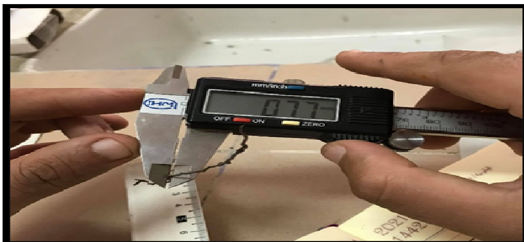
Figure 19 .Mesure du diamètre des racines avec un pied à coulisse électronique.
