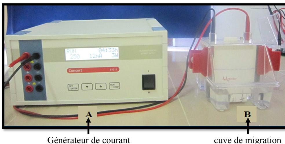
**Figure 11: Photographie d'une unité d'électrophorèse (HOEFFER SE 260).**
