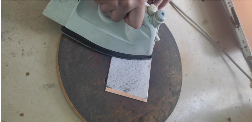
Figure II.18 : Repassage de fer a repassé sur la plaque de cuivre
