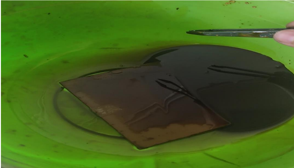
Figure II.20 : dissolution du cuivre dans le perchlorure de fer
