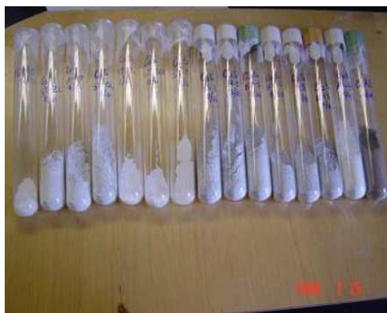
Figure III.15 : Échantillons Préparés de Nano-Ciment [42], [43]
