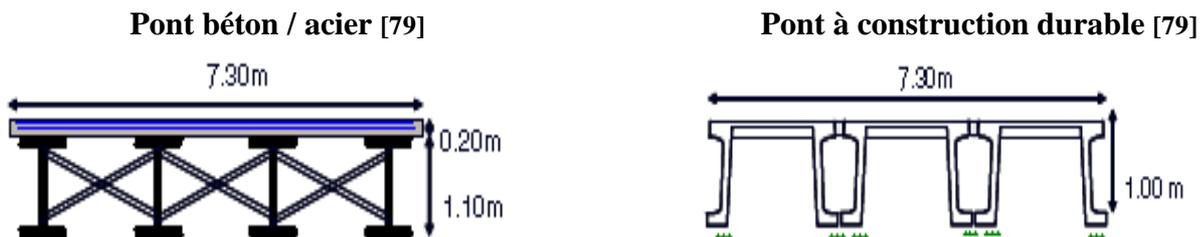
Par rapport à la solution béton / acier, le pont en construction durable permet :
