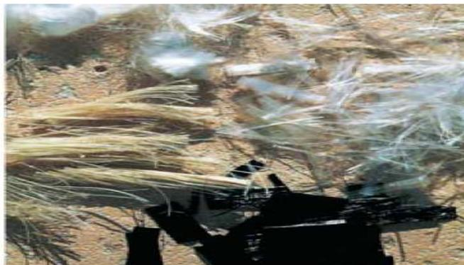
**Figure III.8 : Exemples de fibres polypropylènes [32]**
