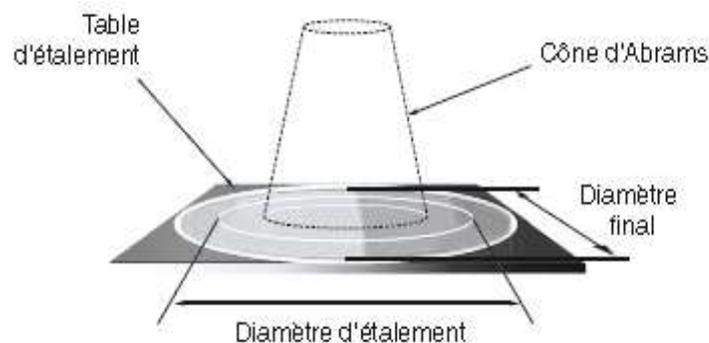
**Figure III.4 : Essai au cône d'Abrams [32]**
