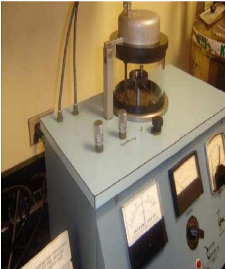
**Figure III.16 : Instrument de pulvérisation**
