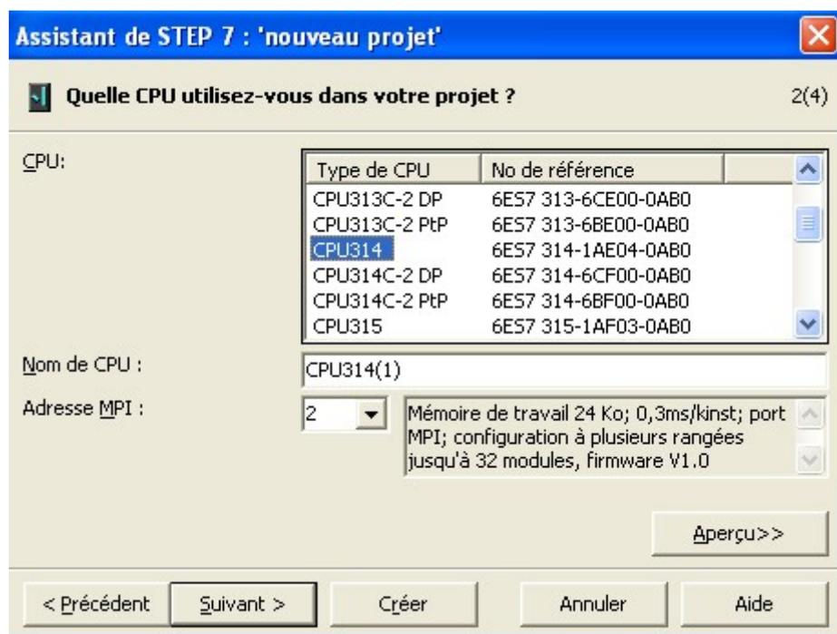
Figure (IV- 5): sélection de la CPU 314.
