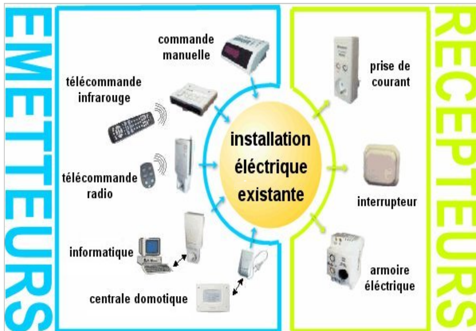
FIGURE I.9 – Communication courant porteur en ligne
