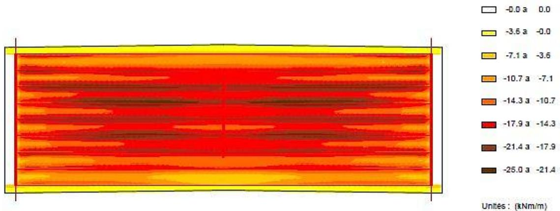
Fig. VI-9 Moment minimum transversal dans la dalle
