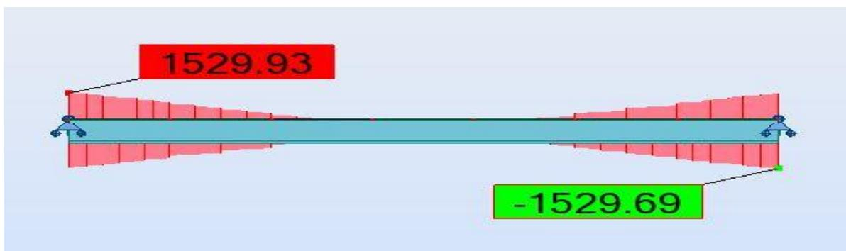
Fig. VI-4 : diagramme de l'effort tranchant sous la combinaison la plus défavorable à l'ELU
