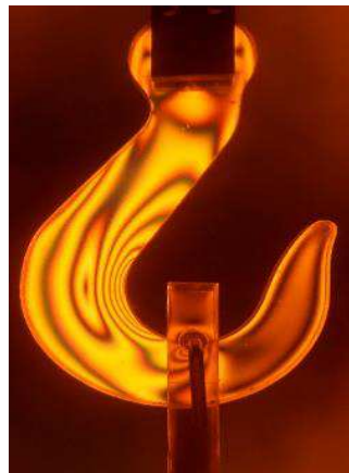
Figure IV.7 Isochromes relevées expérimentalement
