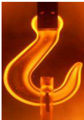
Figure III2 : Observation des contraintes résiduelles sur le crochet
