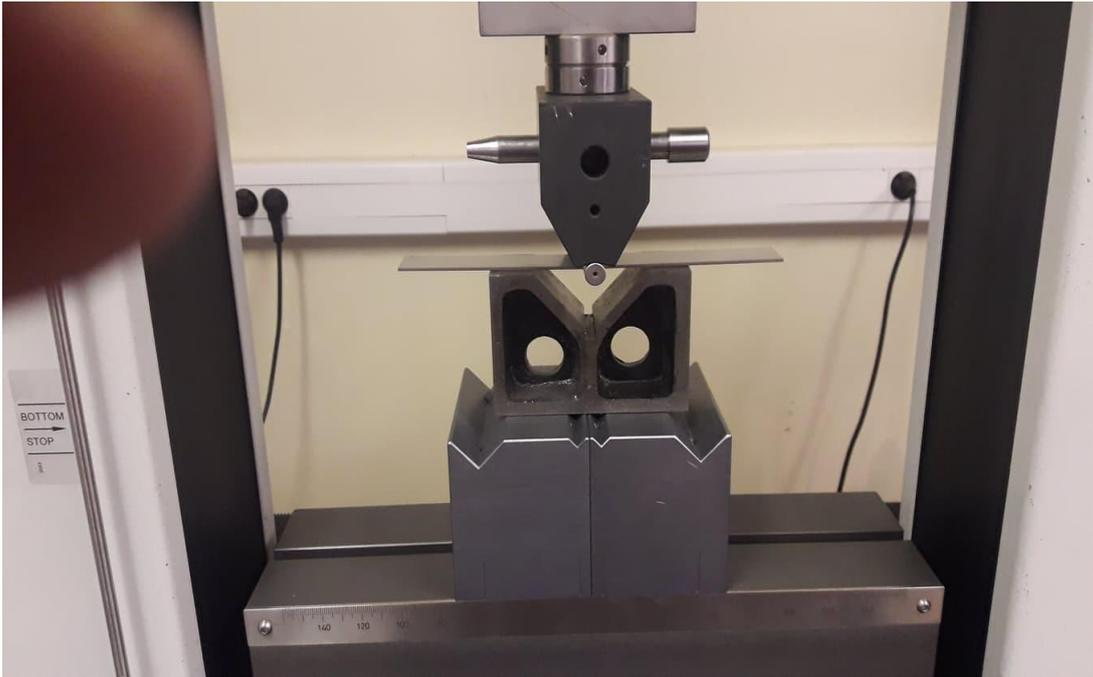
Figure.II.15 : Dispositif de pliage en V
