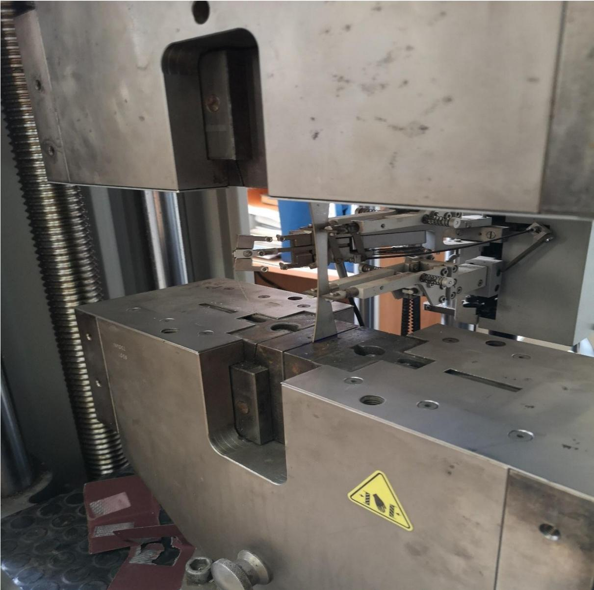
Figure II.4 : Epreuve placer sur la machine de traction Zwick/Roell Z250
