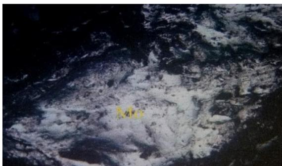
**Figure.VI.26 : microphotographie montrant des cristaux xénomorphes de molybdène (LPAG 10)**
