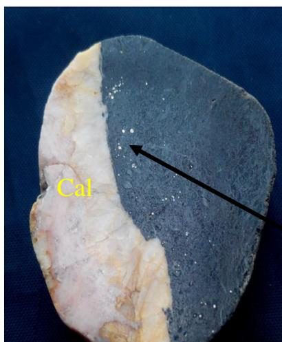
Figure.VI.3 : photographie d'une section polie montrant la sphalérite disséminée
