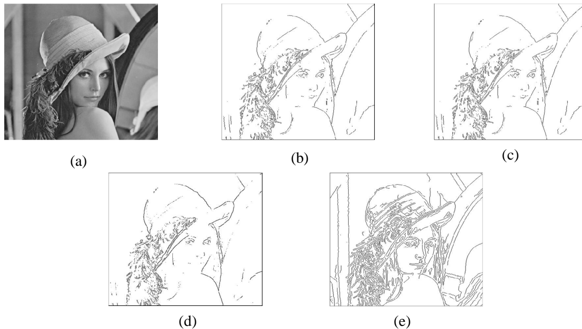
Figure 1.1 : Illustration de détection de contours, a- Image Lenna originale ; b- Détection de contours par filtre de Sobel ; c- Détection de contours par filtre de Prewitt ; d- Détection de contours par filtre de Roberts; e- Détection de contours par filtre de Canny
