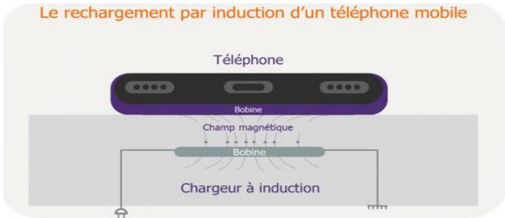
**Figure I.14** : Principe de recharge sans fil par induction [8].
