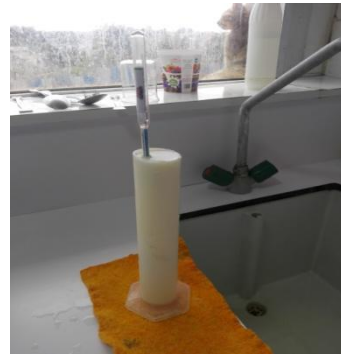
Figure 3 : Mesure de la densité et de température
