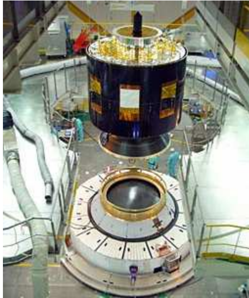
Figure II-1 : Le satellite MSG 2 (Météosat 9) avant sa mise en place à bord du lanceur Ariane 5
