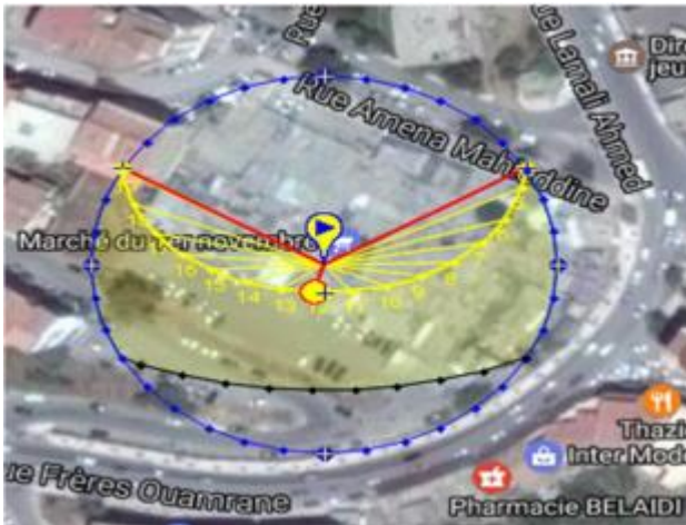
Figure 57: Ensoleillement de l'assiette d'intervention en été
