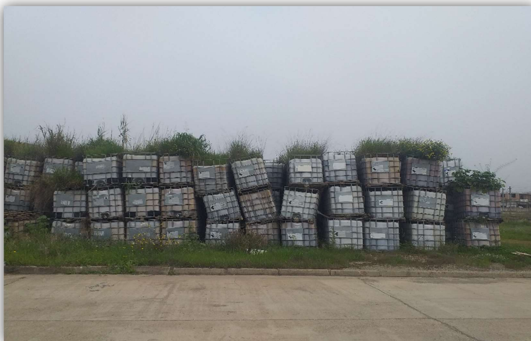
Figure 62 : Cuves de stockage des boues à l'air libre (Originelle, 2022)
