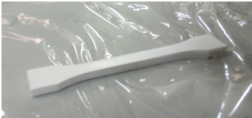
Figure V-16: Echantillon obtenu après le processus de compactage
