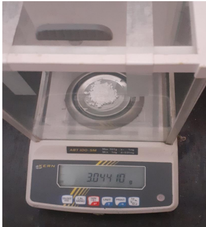
Figure V-3: Peser la poudre sur la balance
