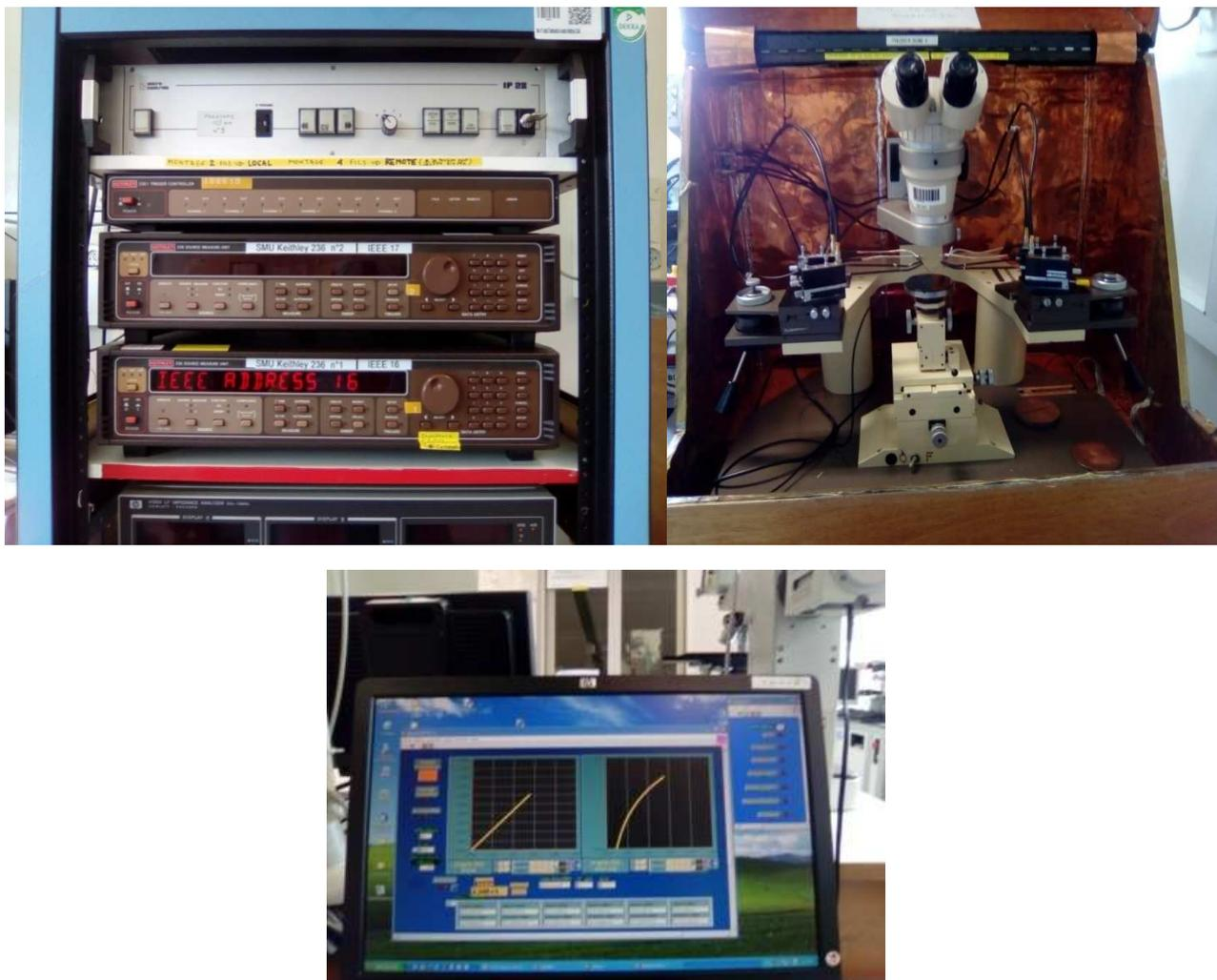
**Figure III- 14.** Banc pour test sous pointes à 4 manipulateurs (PROBER SOM4 –CTU-IEF)
