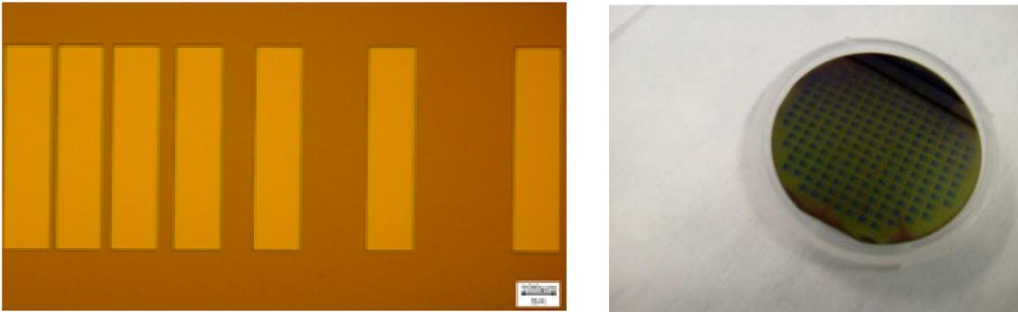
**Figure IV- 11** Photo d'une structure TLM réalisée. La largeur des plots est de  $140\ \mu\text{m}$  et de longueur  $1\ \text{mm}$  et les distances de séparation sont de  $10, 20, 50, 100, 200$  et  $300\ \mu\text{m}$ .
