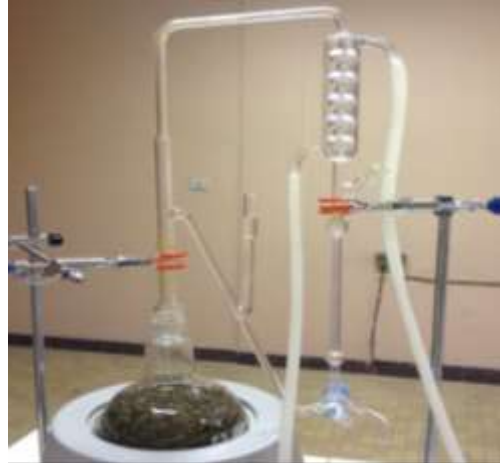
Figure 7 : Dispositif d'hydrodistillation (type Clevenger) utilisé pour l'obtention des huiles essentielles
