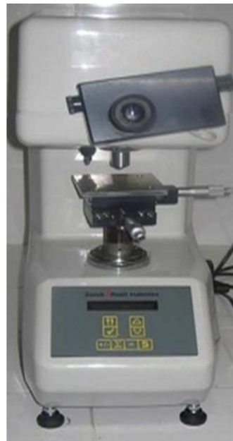
Figure IV.9 : Duromètre ZWICKROELZHV1M Model Tester
