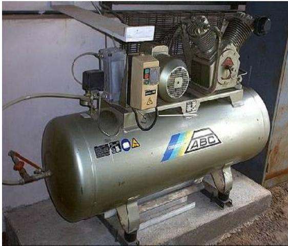
Figure V.5 : Compresseur d'air 15 bars.
