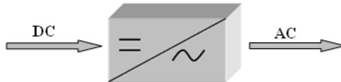
Figure I.20 : Schéma descriptif de l'onduleur.
