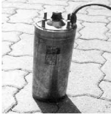
Figure I.16 : Moteur utilisé pour les pompes.
