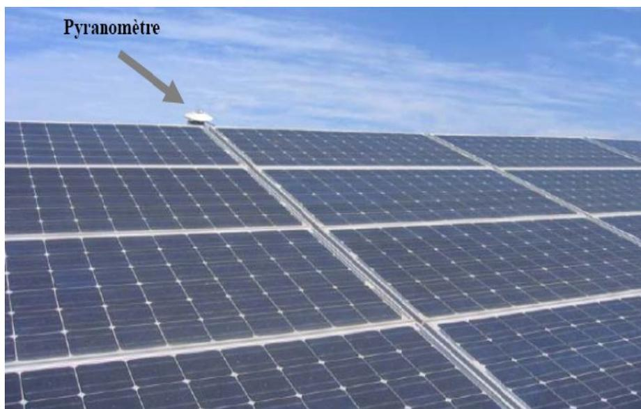
Figure I.5 : Mesure de l'irradiation par un pyranomètre.
