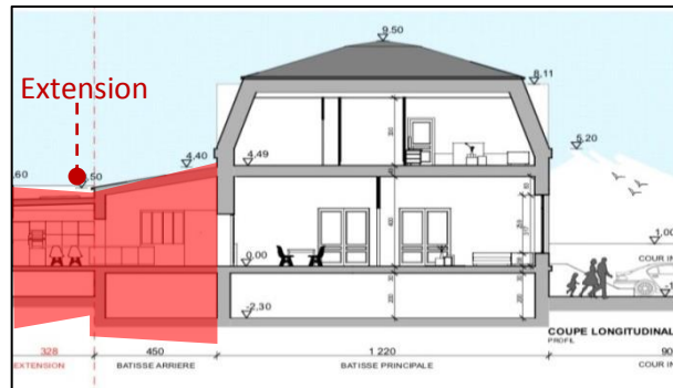
Figure II.04 : Coupe verticale bâtisse principale et l'extension Source : www.amoe-lemaistre.fr
