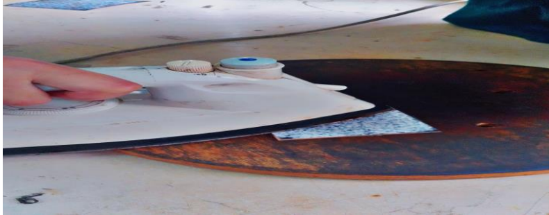
Figure 3.13 : poser le fer à repasser sur le typon.
