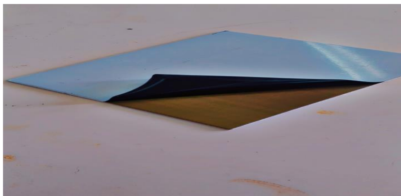
Figure 3.12 : Enlever la protection de la plaque
