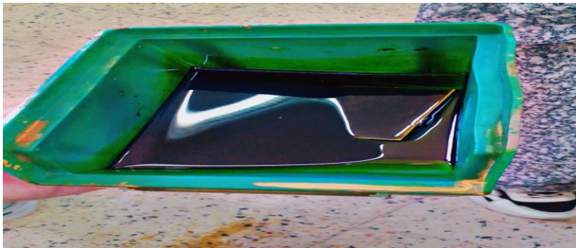
Figure 3.14 : la plaque dans du perchlore de fer.
