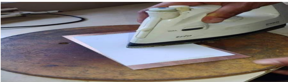
Figure 72 : transfert du circuit à l'aide d'un fer à repasser
