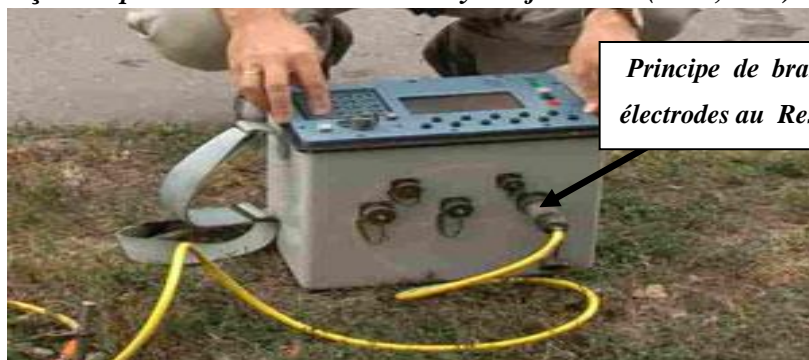
Figure 2.8 : Façade supérieure du Résistivimètre Syscal junior R1 (AGC, 2012).
