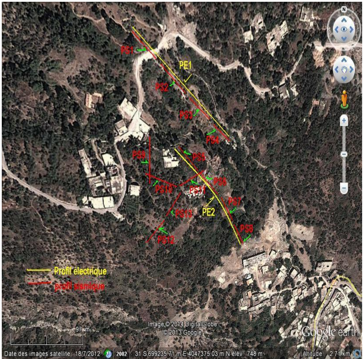
Figure 4.4 : Positionnement des profils électrique et sismique sur site village Echetal.
