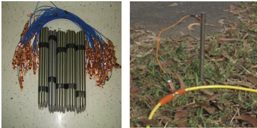
Figure 2.11 : Connexion d'une électrode au câble multi électrode.
