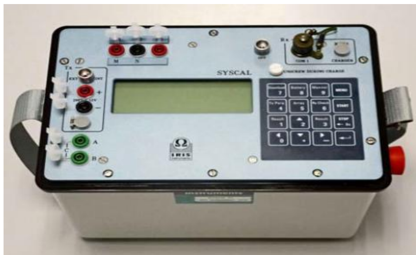
Figure 2.8 : Façade supérieure du Résistivimètre Syscal junior R1 (AGC, 2012).
