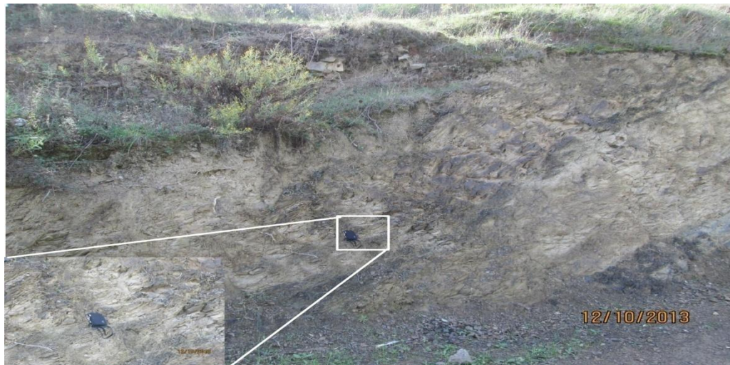
Figure 4.14 : Coupe naturelle montrant l'importance de la formation de marne schisteuse du site Ouled Ali.
