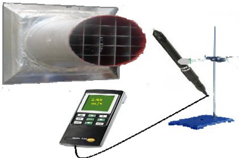
Figure V.3 : technique de mesure du débit d'air
