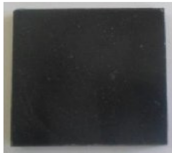
Figure IV.20 : le composite utilisé (Pa 60%, Pe 35%, Gr 5%)
