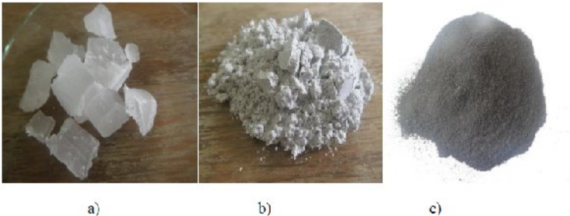
Figure IV.22 : Matériaux utilisés : a) la paraffine b) la perlite c) le graphite
