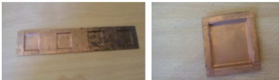
Figure IV.7 : Pièces finales après emboutissage
