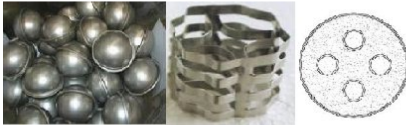
Figure II.8 : Représentation des différents types d'Incorporation des MCP dans des structures métalliques.
