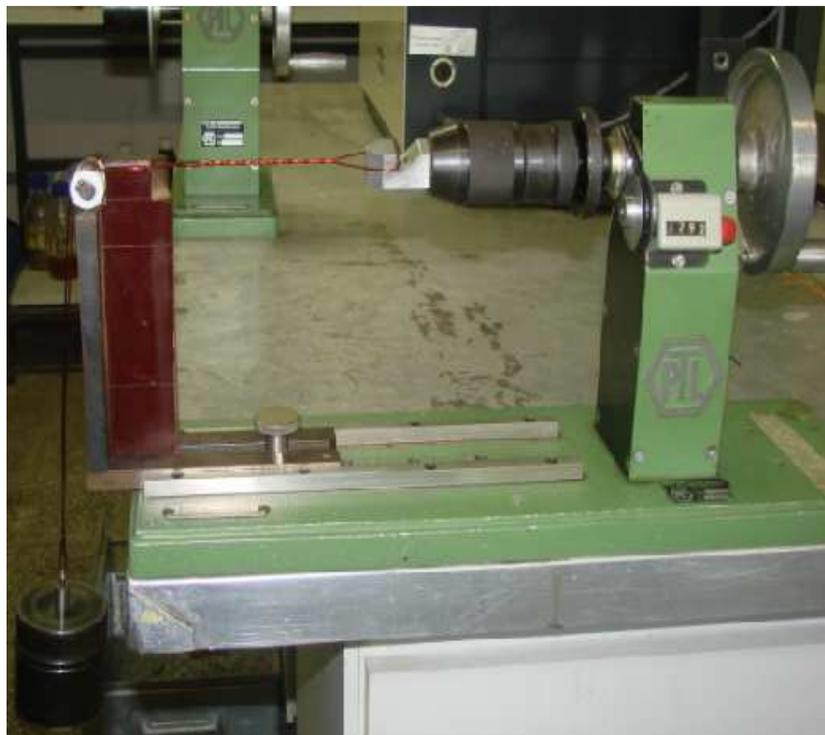
Figure 6. Tour à bobiner servant à réaliser des éprouvettes.
