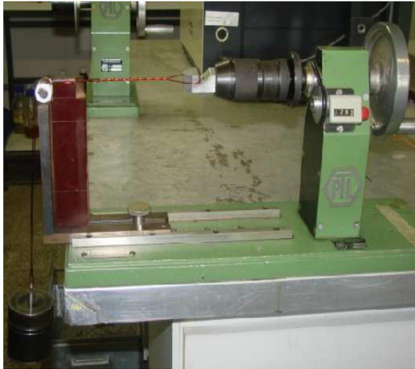
Figure III.11. Tour à bobiner servant à réaliser des éprouvettes.
