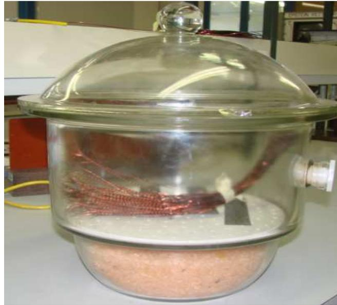
Figure III. 15. Ensemble dessiccateur et échantillons en cours de conditionnement.
