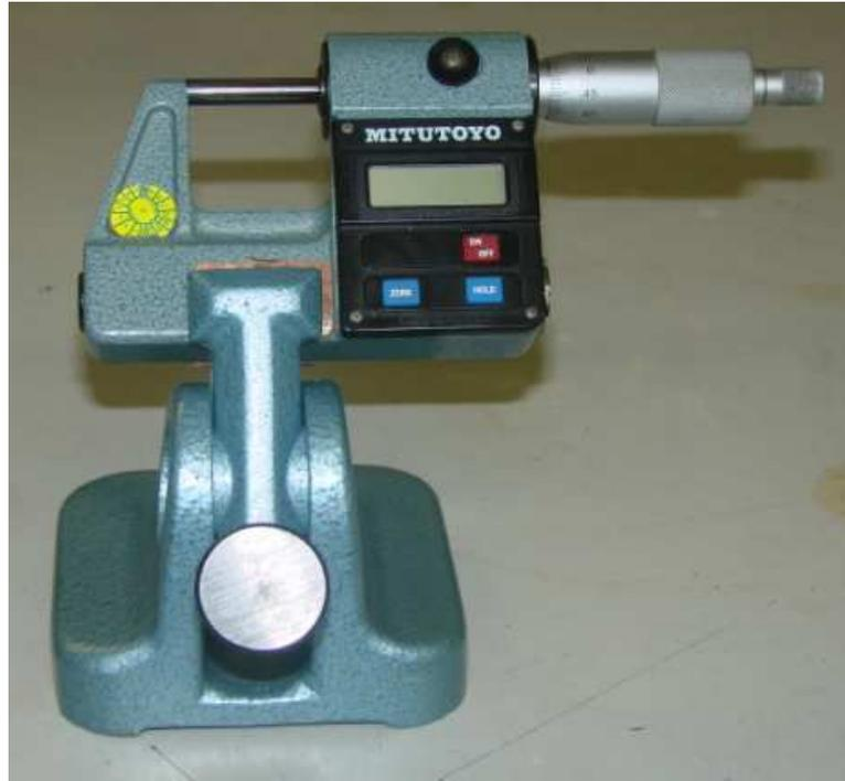
Figure III. 2. Palmer électronique utilisé pour la mesure du diamètre.
