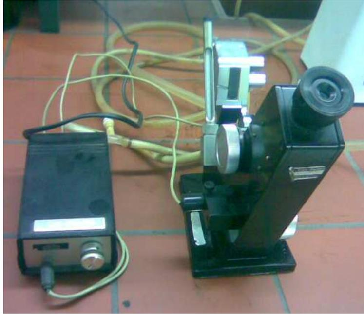
Figure 9. Réfractomètre de type AR4 utilisé pour la mesure de l'indice de réfraction.
