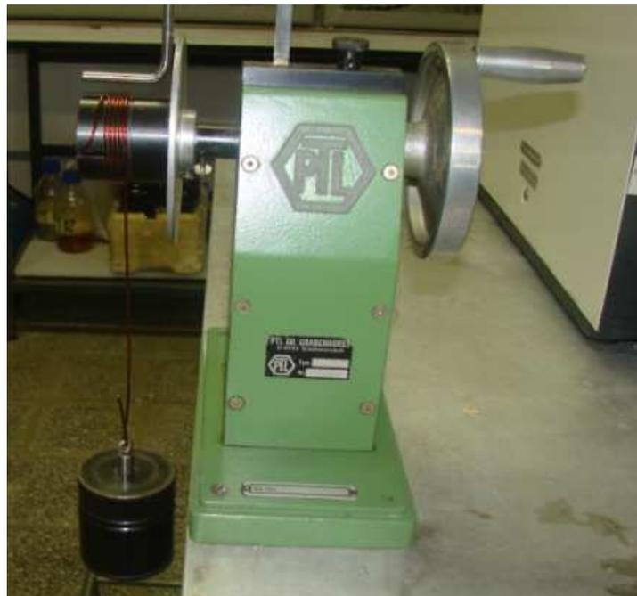
Figure III.6. Dispositif utilisé pour mesurer l'effet ressort.
