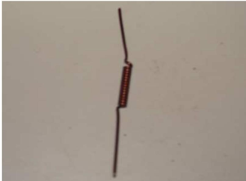
Figure III.7. Eprouvette utilisée dans l'essai de choc thermique.
