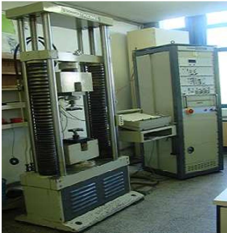
Figure III.10. Machine de traction utilisée pour les essais mécaniques.
