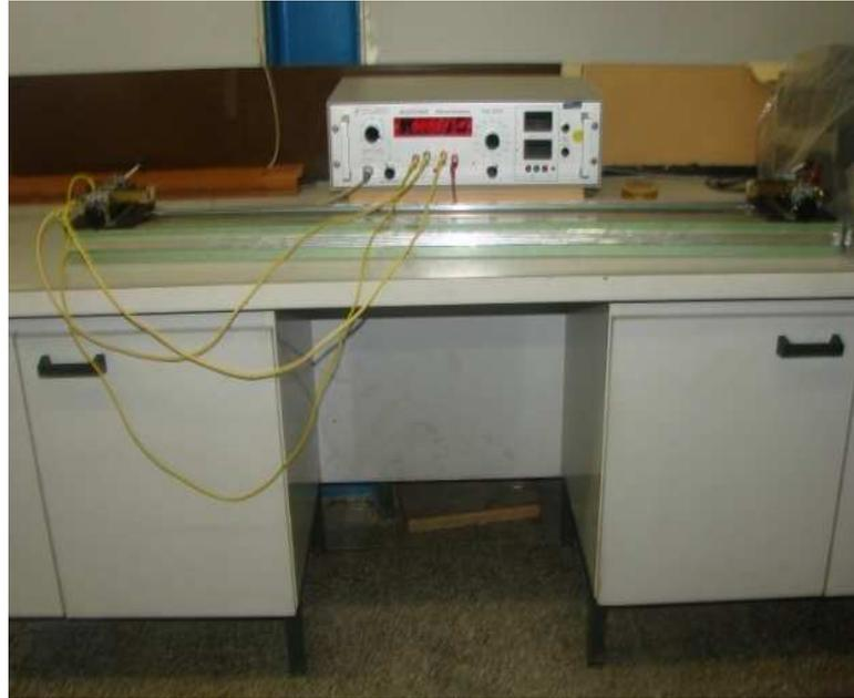
Figure III.9. Ohmmètre utilisé pour la mesure de la résistance du fil de cuivre.
