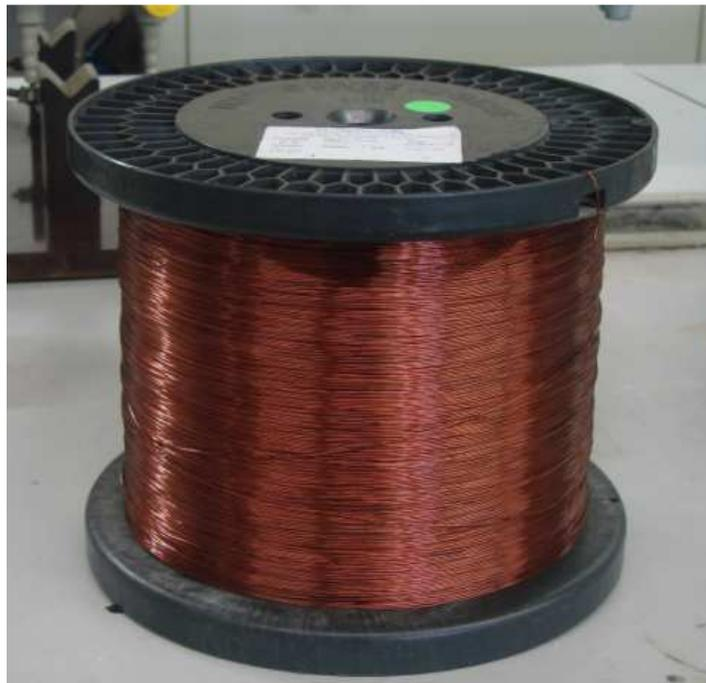
Figure III.1. Bobine de fil de cuivre émaillé au polyamide
