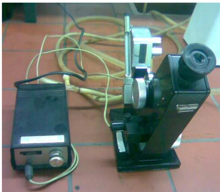
Figure III.14. Réfractomètre de type AR4 utilisé pour la mesure de l'indice de réfraction.
