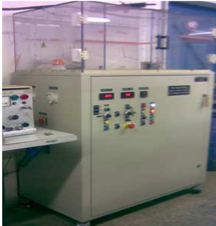
Figure 11. Générateur de haute tension utilisé pour les essais de claquage.
