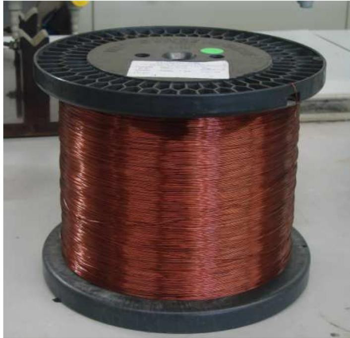
Figure 5. Bobine de fil de cuivre émaillé au polyamide imide.
