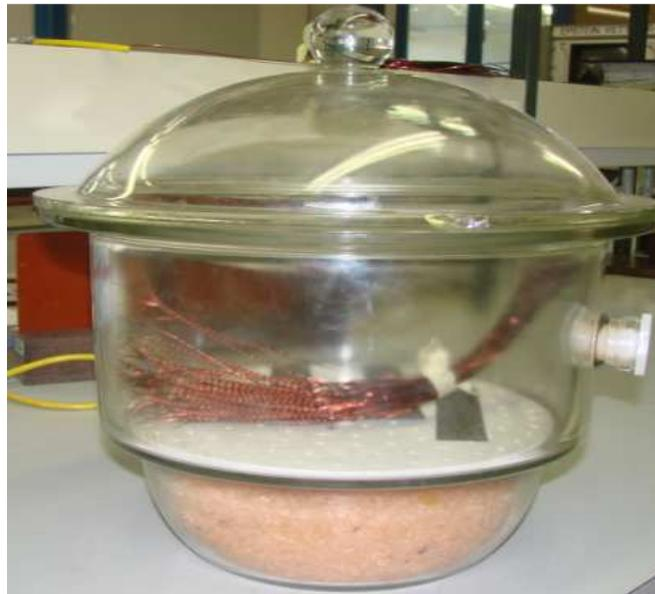
Figure 10. Ensemble dessiccateur et échantillons en cours de conditionnement.
