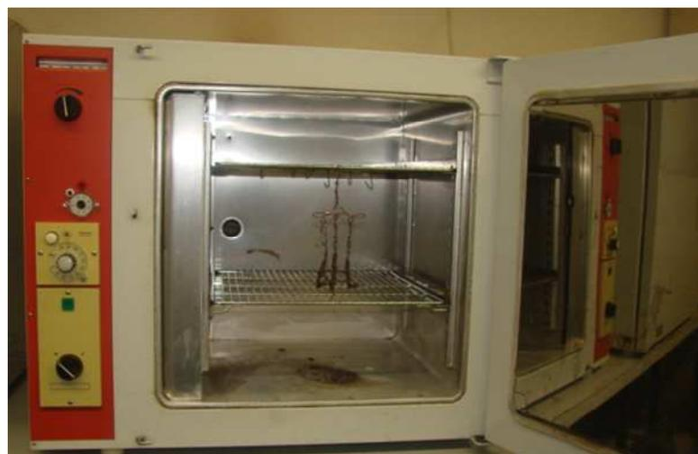
Figure III.8. Etuve à air pulsé utilisée pour l'essai de choc
