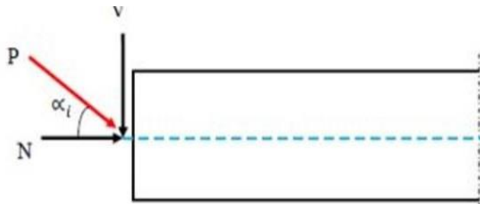
Figure VIII.10. Composante de la force précontrainte
