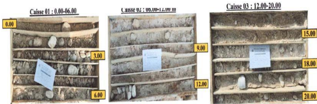
Figure II.4. Caisses de sondage carotté SC02 au milieu de ouad
