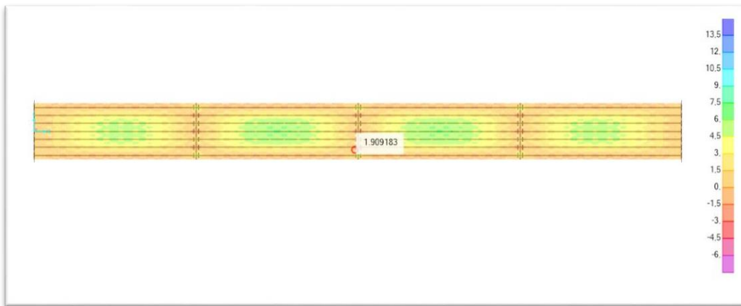
Figure VII.3. Moment fléchissant longitudinal à l'ELU
