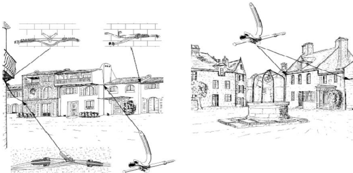
Figure I.7: Les éléments de fixation des câbles torsadés sur façade.
