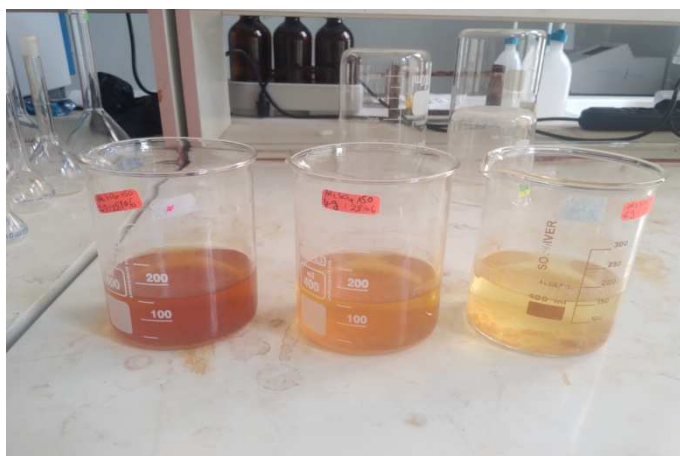
Image III.5 : Surnageant avec différentes doses de K_2S_2O_8 (10, 20 et 40 g/L du plus foncé au plus claire)
