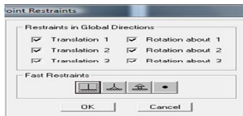
fig : encastrement des appuis
