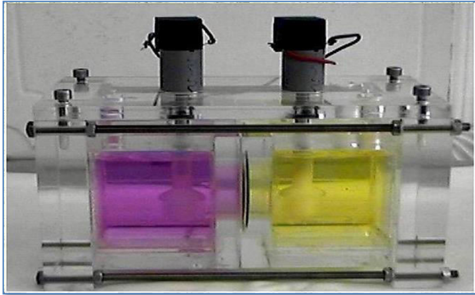
Figure III.7: La cellule de transport des ions métalliques à travers une MLS ou une MPI.
