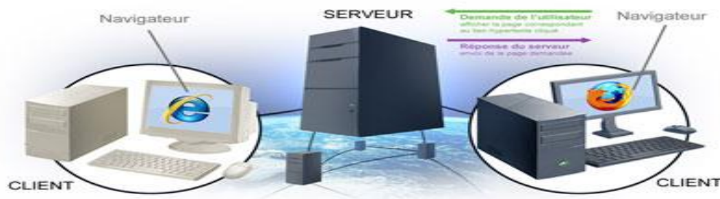
Figure I.18 : fonctionnement d'un site statique.
