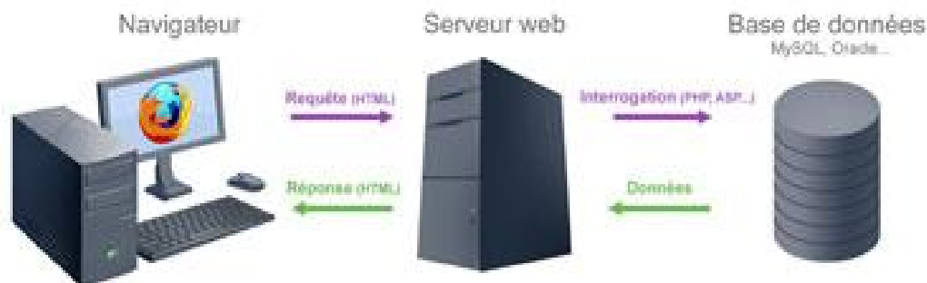
Figure I.19 : fonctionnement d'un site dynamique.
