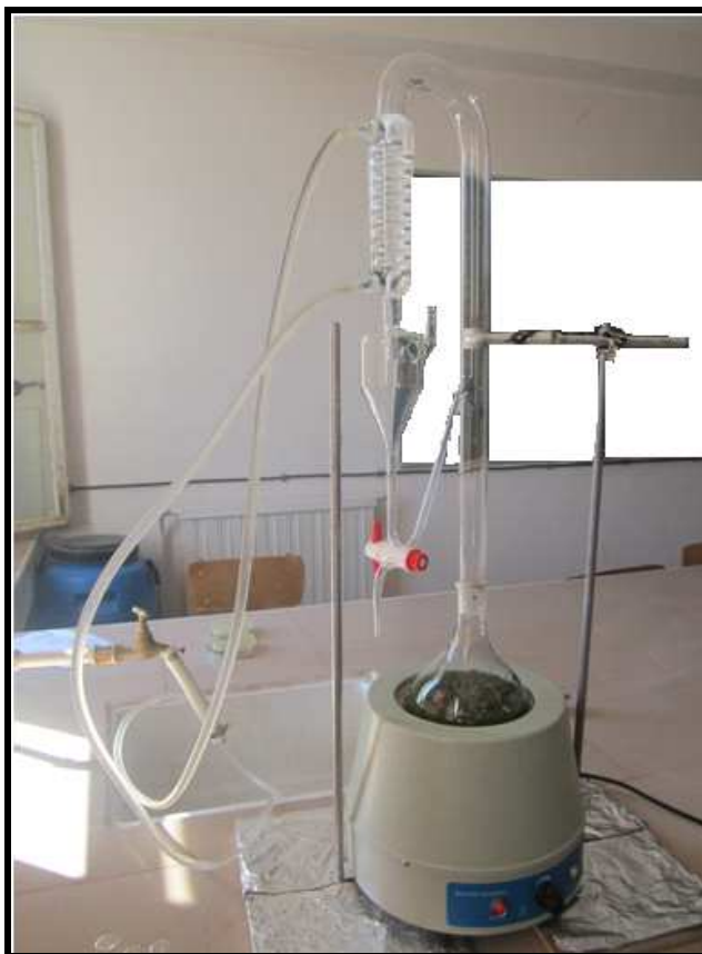
Figure 17. Montage d'un hydrodistillateur (Original, 2015).
