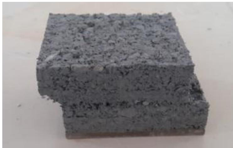
Figure VI.9 : Échantillon après cisaillement.
