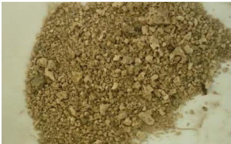
Figure II.11 : Laitier granulé
