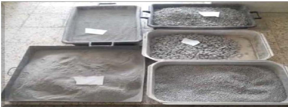
Figure III.6 : Granulats de la marne après concassage.
