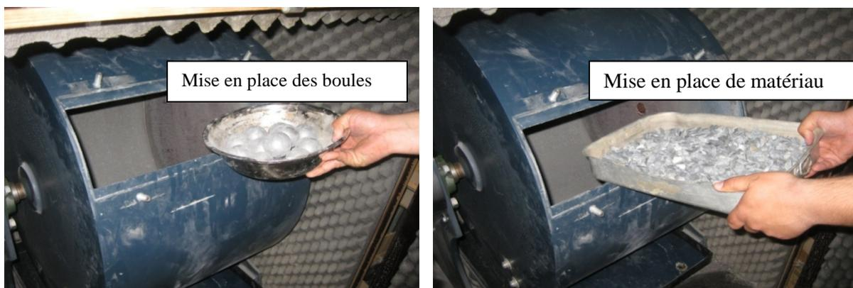
Figure V.4 :Mise en place des granulats pour l'essai Los Angeles
