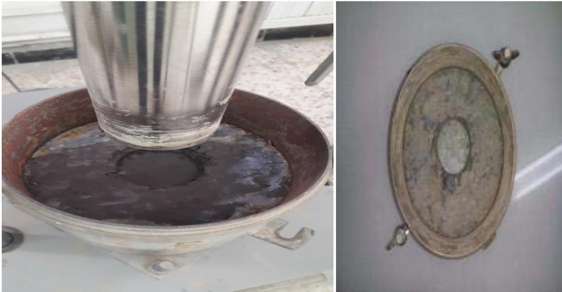
Figure IV.20: Éprouvette après le poinçonnement
