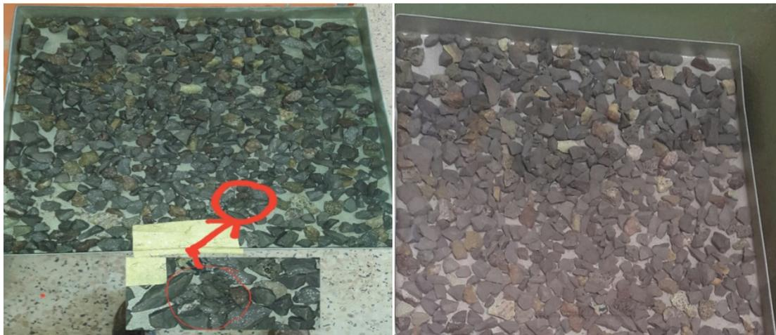
Figure V.13 : Dégradation du matériau sous sollicitations hydriques
