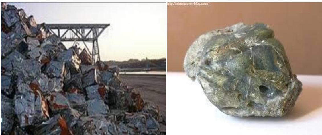
Figure II.9 : Laitiers d'élaboration d'aciers carbone en filière électrique.
