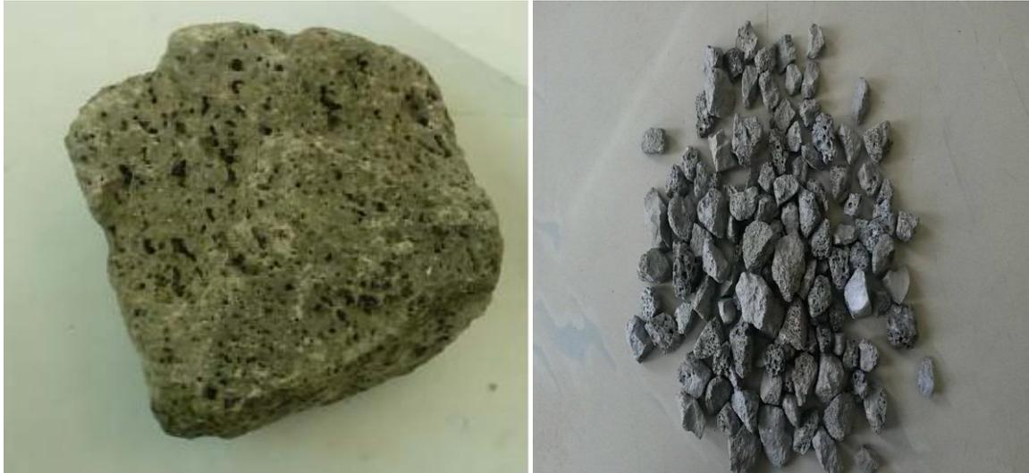
Figure II.12 : Laitier cristallisé.
