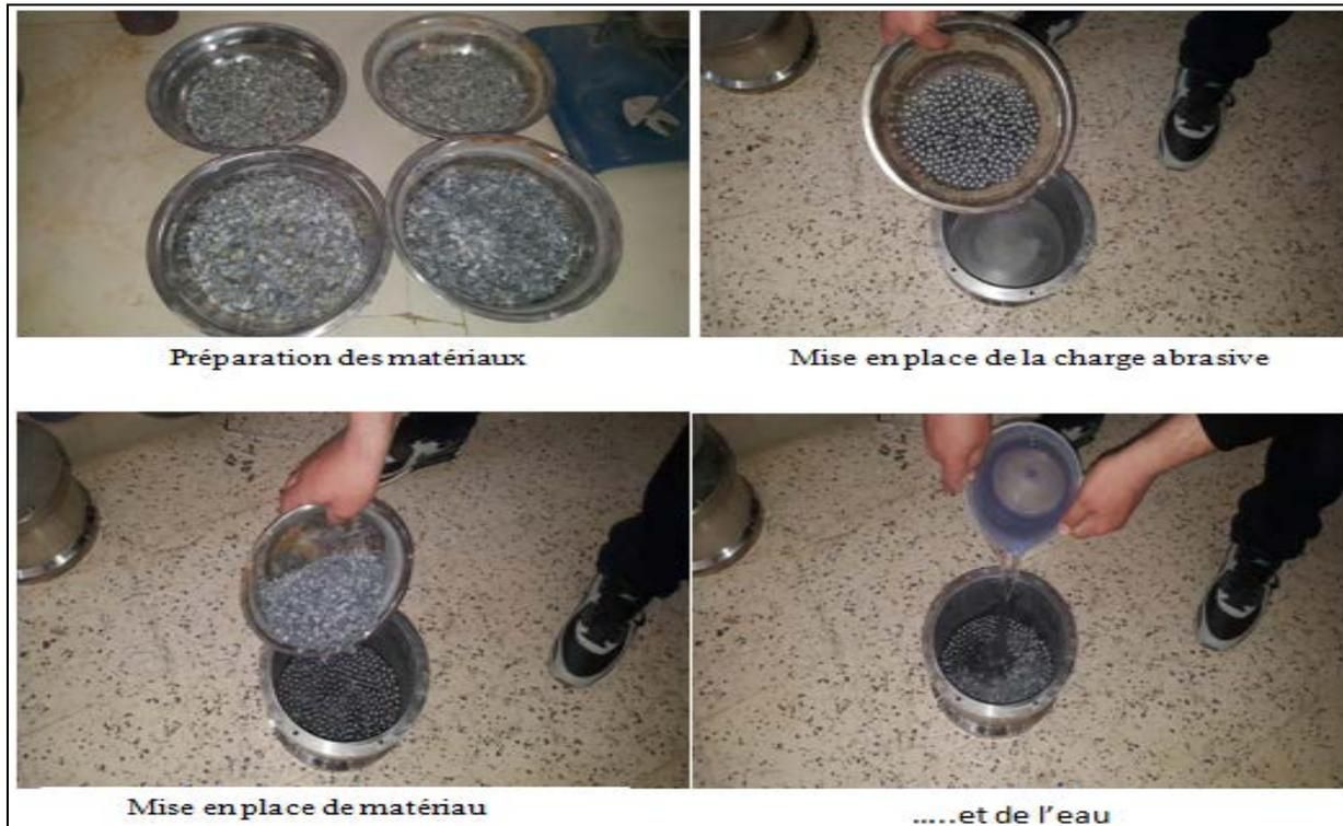
Figure V.2 : Mise en place des granulats pour l'essai.
