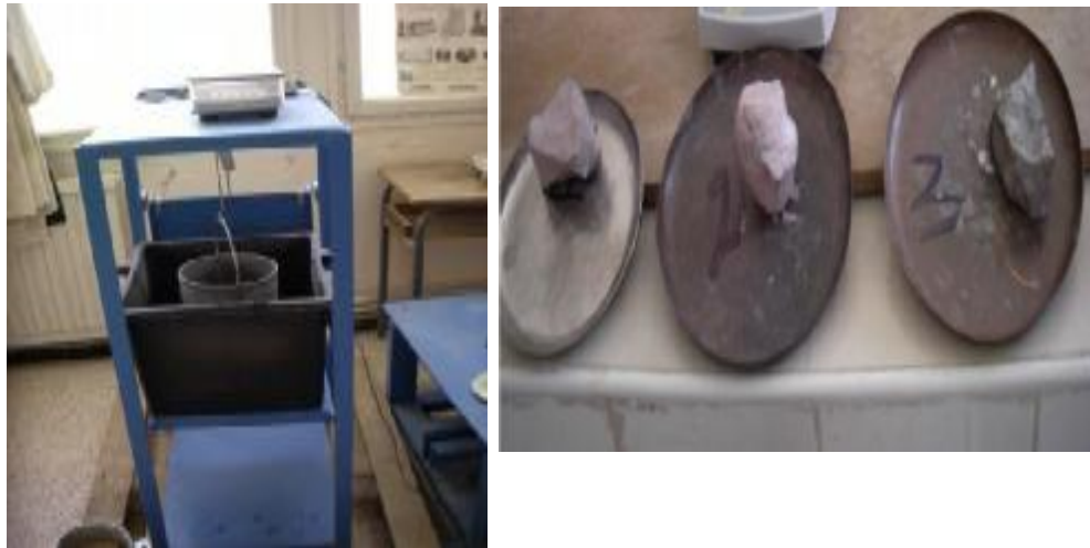
Figure II.3 : Principe et matériels de la pesée hydrostatique.
