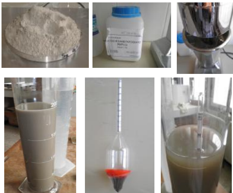
Figure II.10 : Principales étapes de la sédimentométrie.
