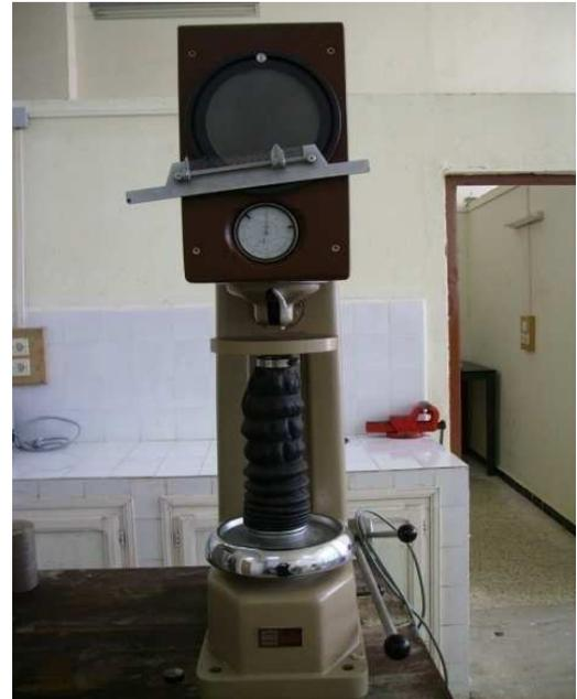
**Fig. II.1.23 – Duromètres**
