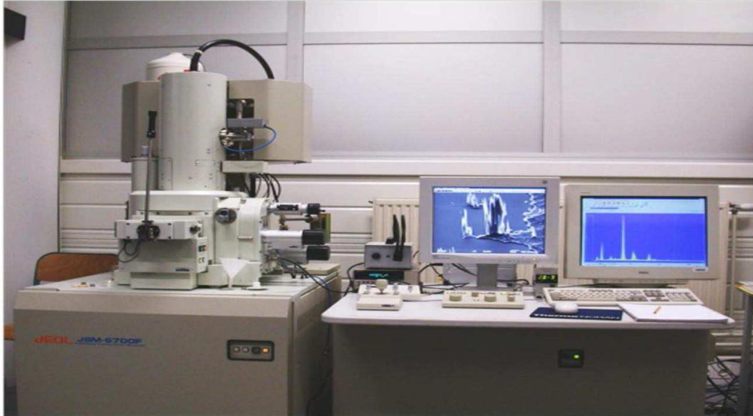
**Fig. II.1.27 - Microscope électronique à balayage (MEB)**
