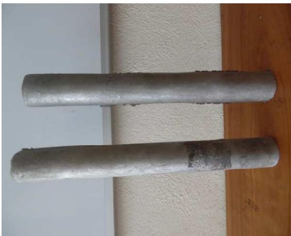
**Fig. II.1.9 - Cylindres moulés en coquille**
