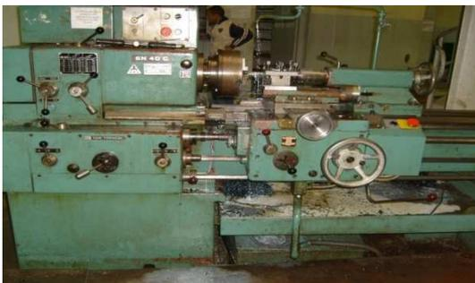
**Fig. II.1.12** - Tour universel de type SN40SN50C
