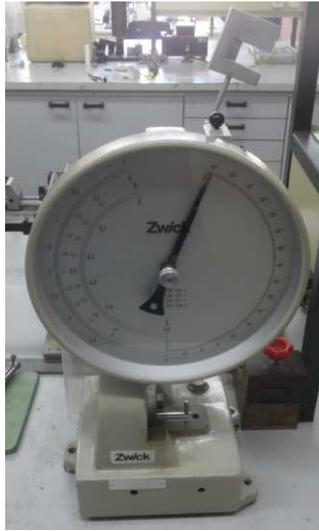
Machine d'essai: Un couteau fixé sur un marteau oscille dans un plan vertical autour d'un axe O. Une partie de l'énergie emmagasinée dans la chute du pendule est utilisée pour rompre l'éprouvette. Le centre de gravité du pendule est toujours voisin à l'arête de couteau du pendule.
