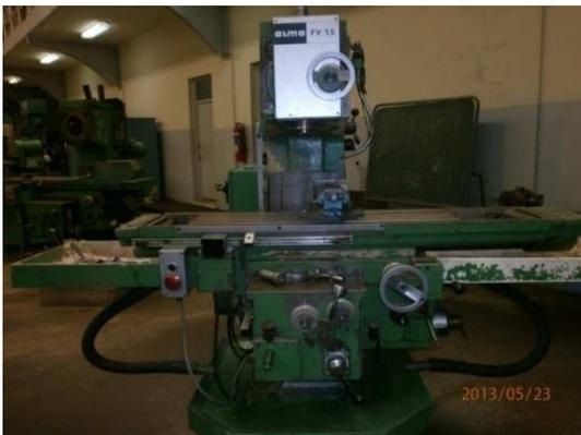
**Fig. II.1.11** - fraiseuse verticale FV1,5 ALMO
