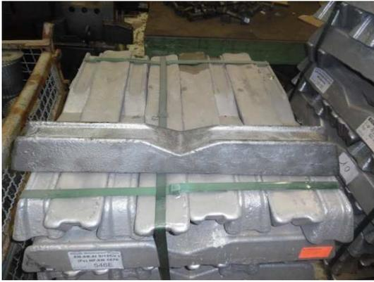
**Fig. II.1.3** - Lingots d'aluminium en AlSi10Mg et AlSi22
