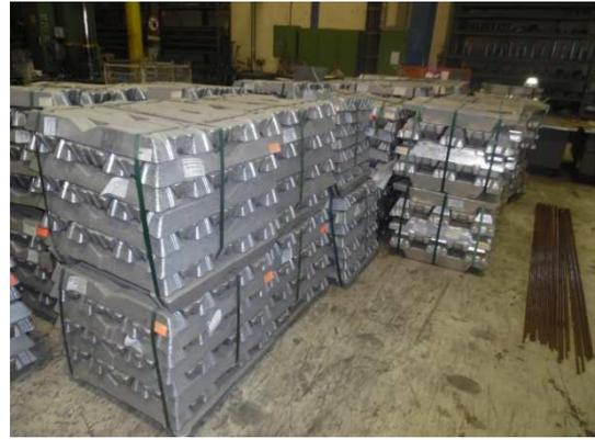
**Fig. II.1.4** - Lingots d'aluminium en AlCu10, AlZn10 et AlMg10
