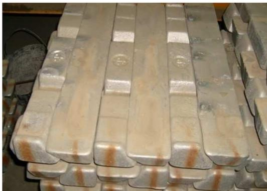
Fig. II.1.1- Lingots d'aluminium en AlSi7Mg
