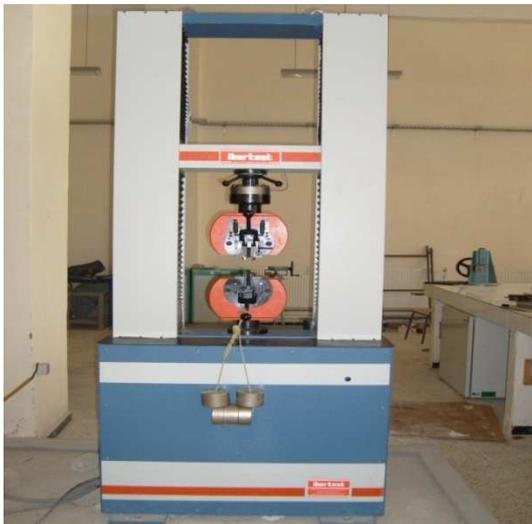
**Fig. II.1.20 -** Machine de traction
