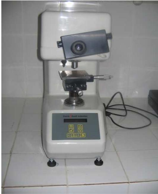
**Fig. II.1.24 – Microduromètre**
