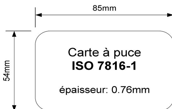
Figure I.i : aspect et dimensions normalisées
