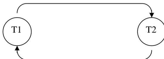
Fig III.o : Exemple de graphe d'attente avec circuit
