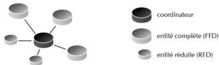
Figure 28: Représentation de la topologie en étoile.
